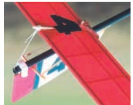
Höhenleitwerk in Bremsstellung. Gut zu sehen das Ruderhorn aus 2-mm-Rundholz und der U-förmige Beschlag aus ABS mit Gewinden für die Feintrimmung
