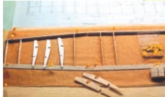
Gebaut wird möglichst nicht auf dem Plan. Es genügen wenige Linien auf einer Unterlage aus Backpapier
