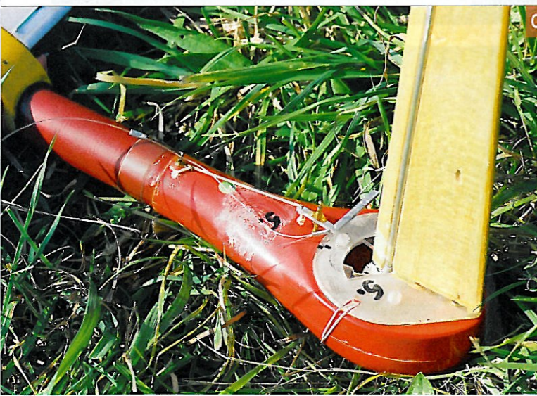
01 Kompasssteuerung von 1937. Schlägt die Kompassnadel aus, schließt sie einen Stromkreis, der das Ruder aktiviert 02 Segelflugmodell „Rhön“, wie es 1941 auf der Wasserkuppe geflogen wurde. Hans Gremmer, 1979 03 Gremmers erste Magnetsteuerung 1953 04 Kurvensteuerung für Magnetsegler: Das weiße Gummiband zieht den Aluminium-Winkel vom Ruderblatt weg. Zum Kreisen wird die Nylonschnur im Zeitschalter eingehängt und blockiert das Ruder – gegen den Gummizug – bis die Zeituhr die Schnur wieder frei gibt
