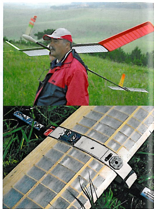
Marian Popescu (ROM) mit seinem Modell state of the art: Carbon-D-Box, Carbon-Holme und Carbon-Rippenstreifen im Flügel - Ein einfacher Flügel Aufbau von Wolfgang Diehl. Fünfter Platz bei der DM 2007.
